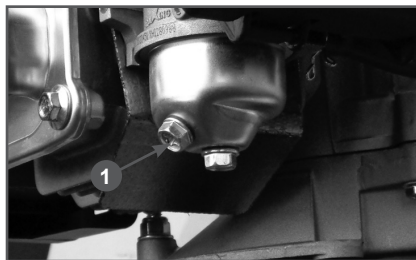
Рис. 20. Слив топлива с поплавковой камеры карбюратора
